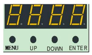
The menu confirms up and down menu key: Select function Up key:, parameter arguments Down key:, parameter parameter Confirm key: Determine and save
